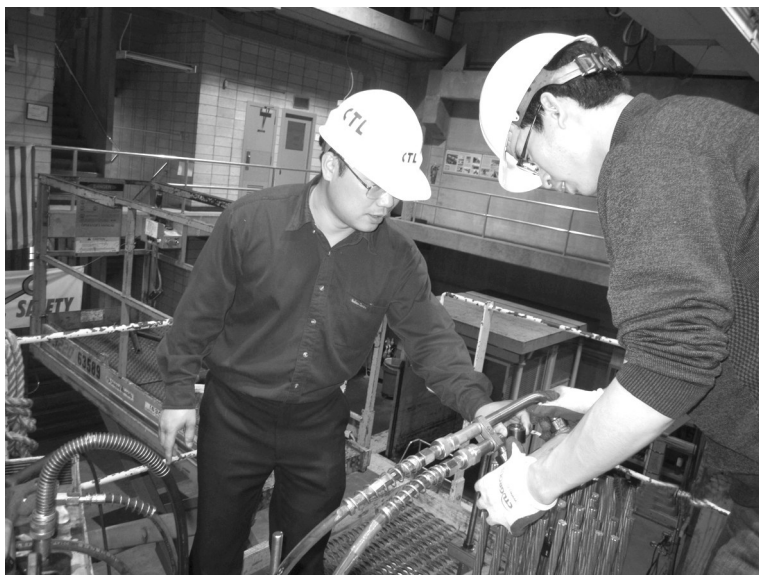
朱万旭（左）在美国CTL试验室进行大型拉索疲劳试验
